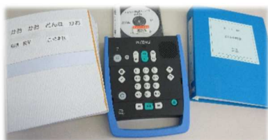
プレクストークPTN3 視覚障害者向け卓上型デイジー図書の再生専用機 音声ガイドで簡単に操作できる
